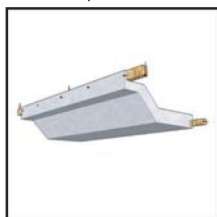
seitlich verkleben/schrauben Platten prov. einsetzen
